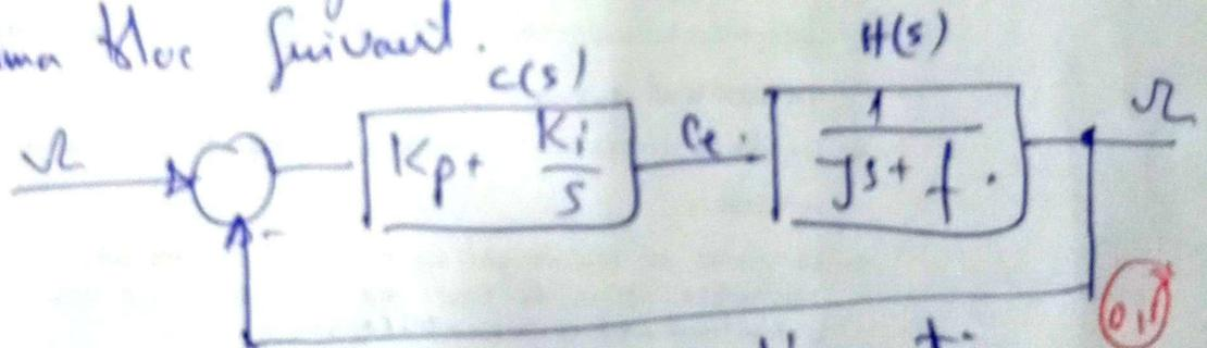
$H(s)$  est déterminé à partir de l'équation Mécanique:
